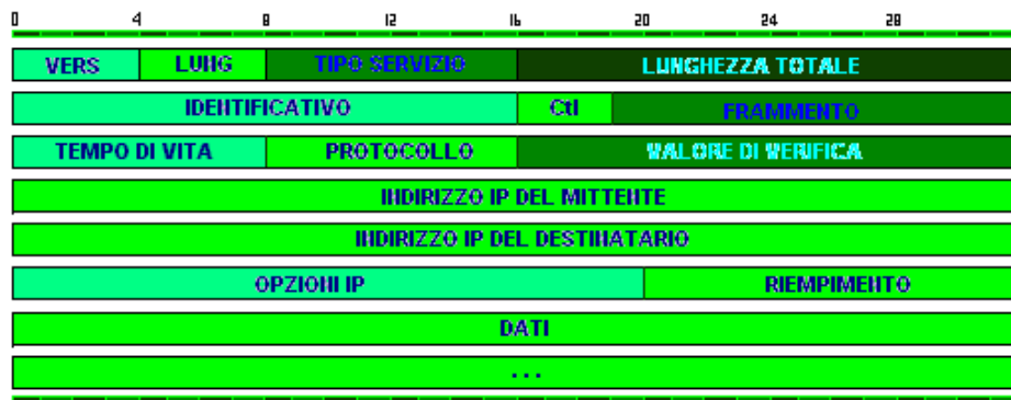
Figura 3.2-1 Datagramma INTERNET - unità base per il trasferimento dati in rete
